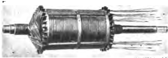
Tambour bipolaire en cours de bobinage.
